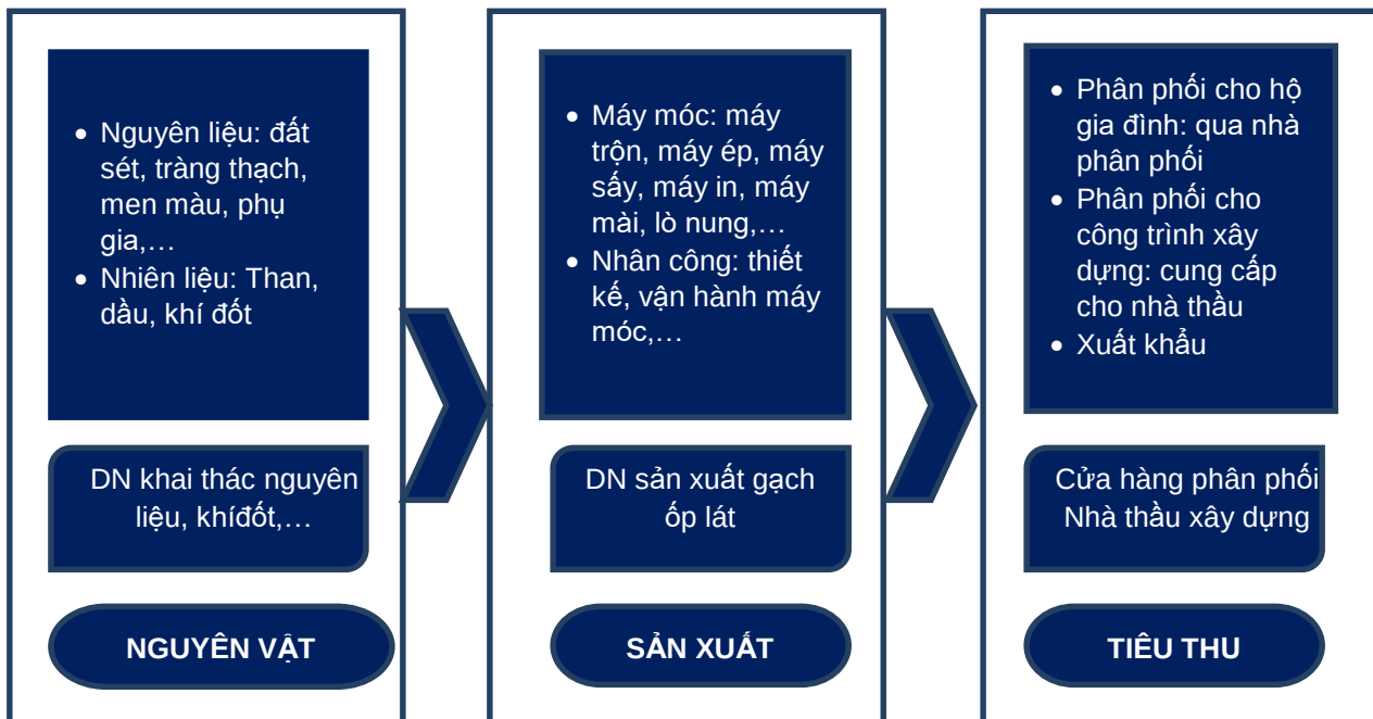
Hình 2: Chuỗi sản xuất của Gạch ốp lát
